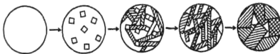
Рис. 10. Схема утворення ситалів шляхом кристалізації скла за участю нуклеаторів
