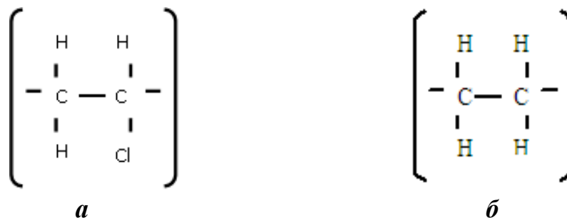
Рис. 7. Схеми молекулярної структури полярного (а) й неполярного (б) полімерів
