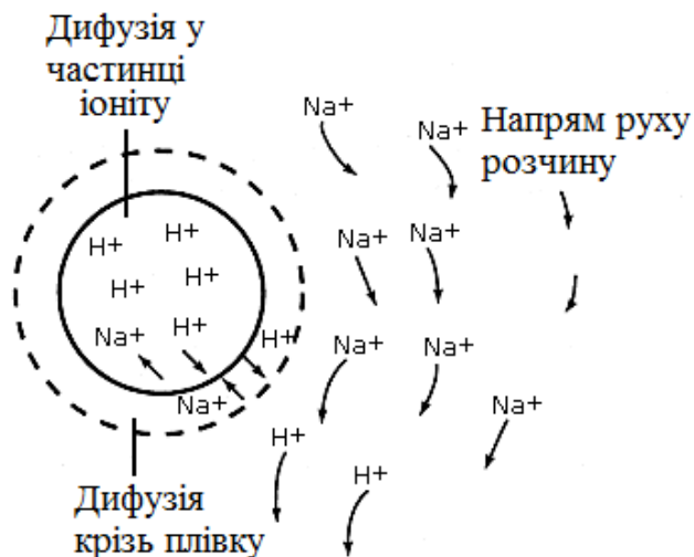
Рис. 4. Схема дифузії іонів крізь плівку і усередині зерна
