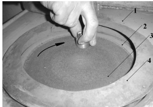
Рис. 9 Рекомендований прийом полірування шліфа на полирувальній установці: 1 – стіл полірувальної установки, 2 – диск, 3 – сукно, 4 – захисний кожух
