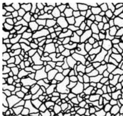
Рис.12 Мікроструктура технічного заліза (ферит), х 100.
